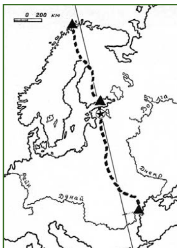
Рис. 1 Схема меридиональной триангуляции Дуги Струве
