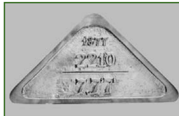
Рис. 2 Общий вид копии нивелирной марки № 2210 конструкции Д.П. Рашкова
